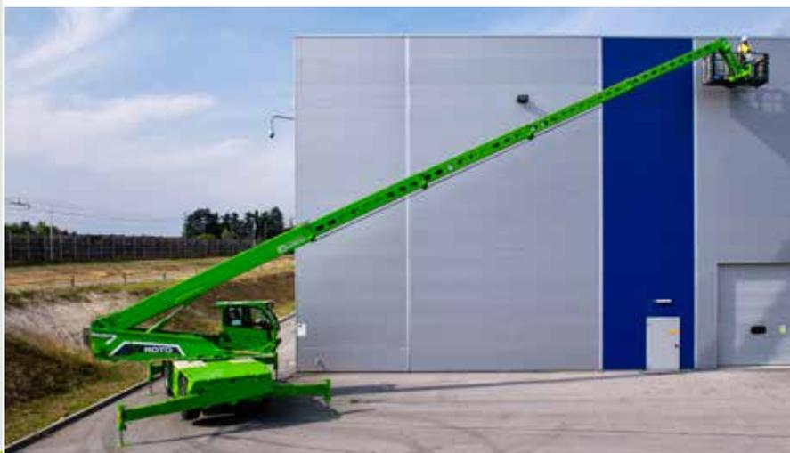
Стрела выполнена в виде двойного профиля С-образного сечения из высокопрочной стали и приварена вдоль нейтральной оси сгиба. Гидравлические трубы и электропроводка внутри стрелы защищены от возможных ударов. Эти функциональные элементы гарантируют:
