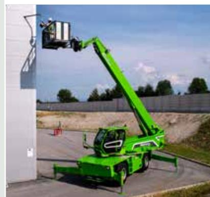
Модели с высотой подъема более 20 метров оснащены аутригерами с регулировкой расстояния выдвижения в зависимости от условий рабочей зоны.
