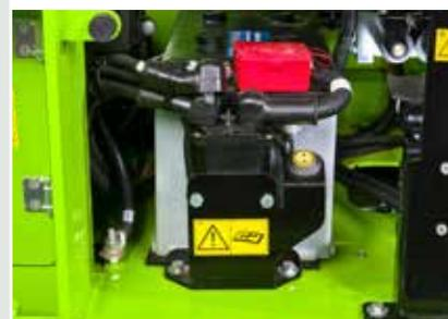
Для повышения эффективности и увеличения срока службы аккумуляторов модели ROTO в стандартной комплектации оснащаются электрическим и автоматическим выключателем аккумуляторной батареи. Когда цепь отключена, достаточно вставить ключ в гнездо на панели управления, чтобы снова активировать батареи.
