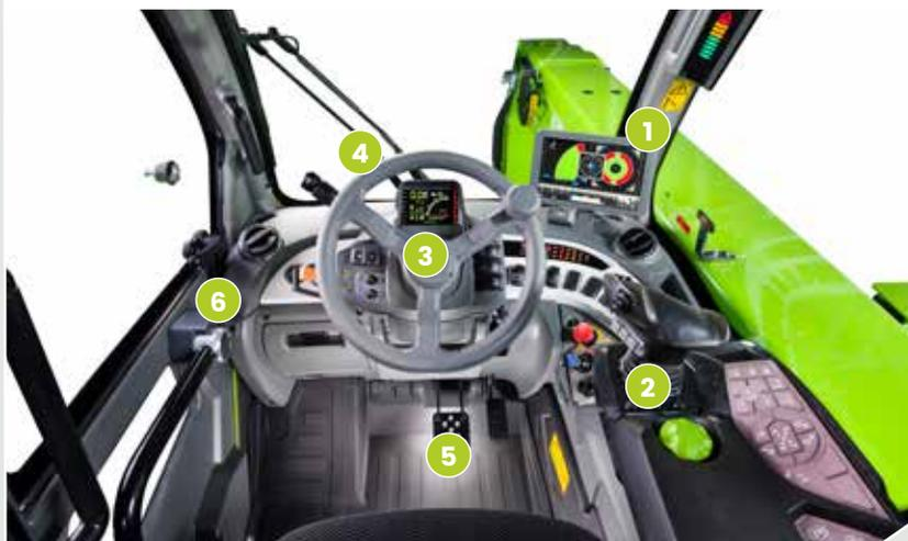
Уникальный дизайн способствует функциональности и комфорту; информация для водителя и органы управления различными системами и устройствами сгруппированы вместе для обеспечения максимальной эргономики рабочего места. Инвертор направления движения на рулевом колесе предусмотрен также на джойстике.
