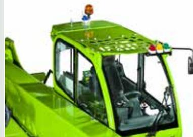
Металлическая конструкция на стеклянной крыше прошла одну из самых строгих сертификаций в области безопасности: FOPS II уровня. Эта сертификация гарантирует:
